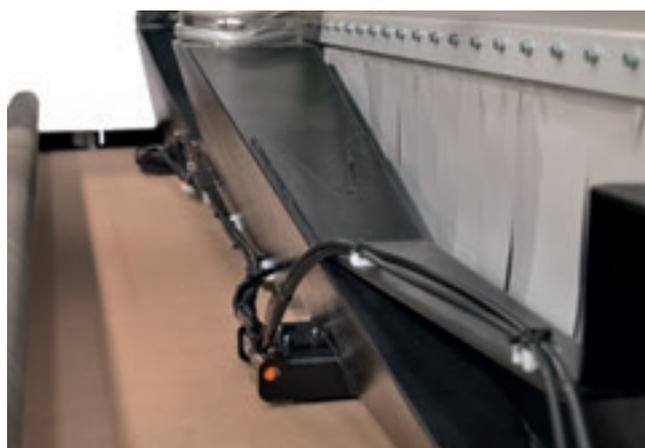
**Sweep arm** con lama regolabile e dispositivo copiatore. Consente lo scarico automatico di pannelli fino a 3 mm di spessore.
