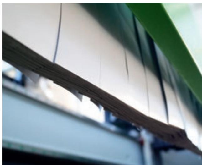
Strati sovrapposti di bandelle laterali a protezione del gruppo operatore.
