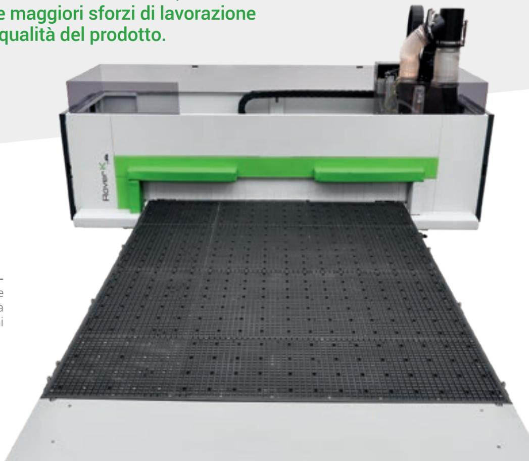
La struttura Gantry con **doppia motorizzazione** è progettata per elevare gli standard di precisione e affidabilità nell'esecuzione di tutte le lavorazioni nesting.
