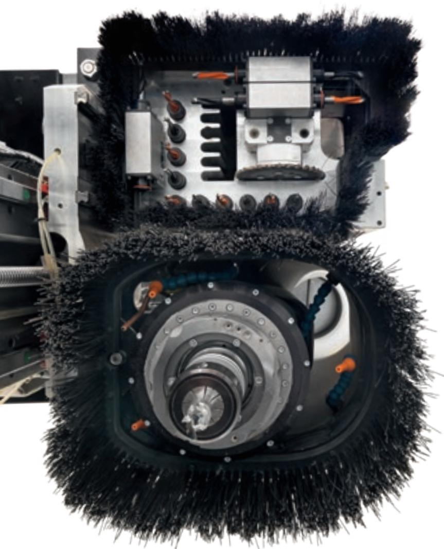
Riduzione dei tempi di cambio utensili e della possibilità di errore dell'operatore, grazie al contatto pre-setter che determina automaticamente la lunghezza dell'utensile.
