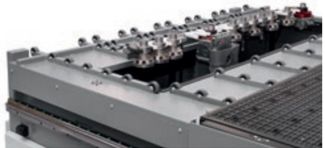
Il magazzino integrato nel basamento garantisce disponibilità di utensili anche con soluzioni di carico automatico, in un minimo ingombro.
