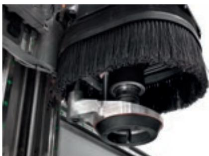
Il **pressatore ad anello** permette la lavorazione di pannelli imbarcati e sovrapposti di materiale traspirante o ad elevato attrito esercitando una pressione sulla faccia superiore del pannello.
