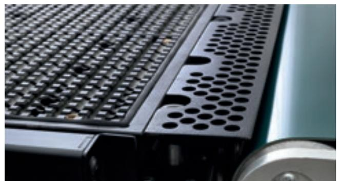
**Sistema di aspirazione** trucioli disposto tra la macchina e il tappeto di scarico, garantisce la massima pulizia dei pezzi.
