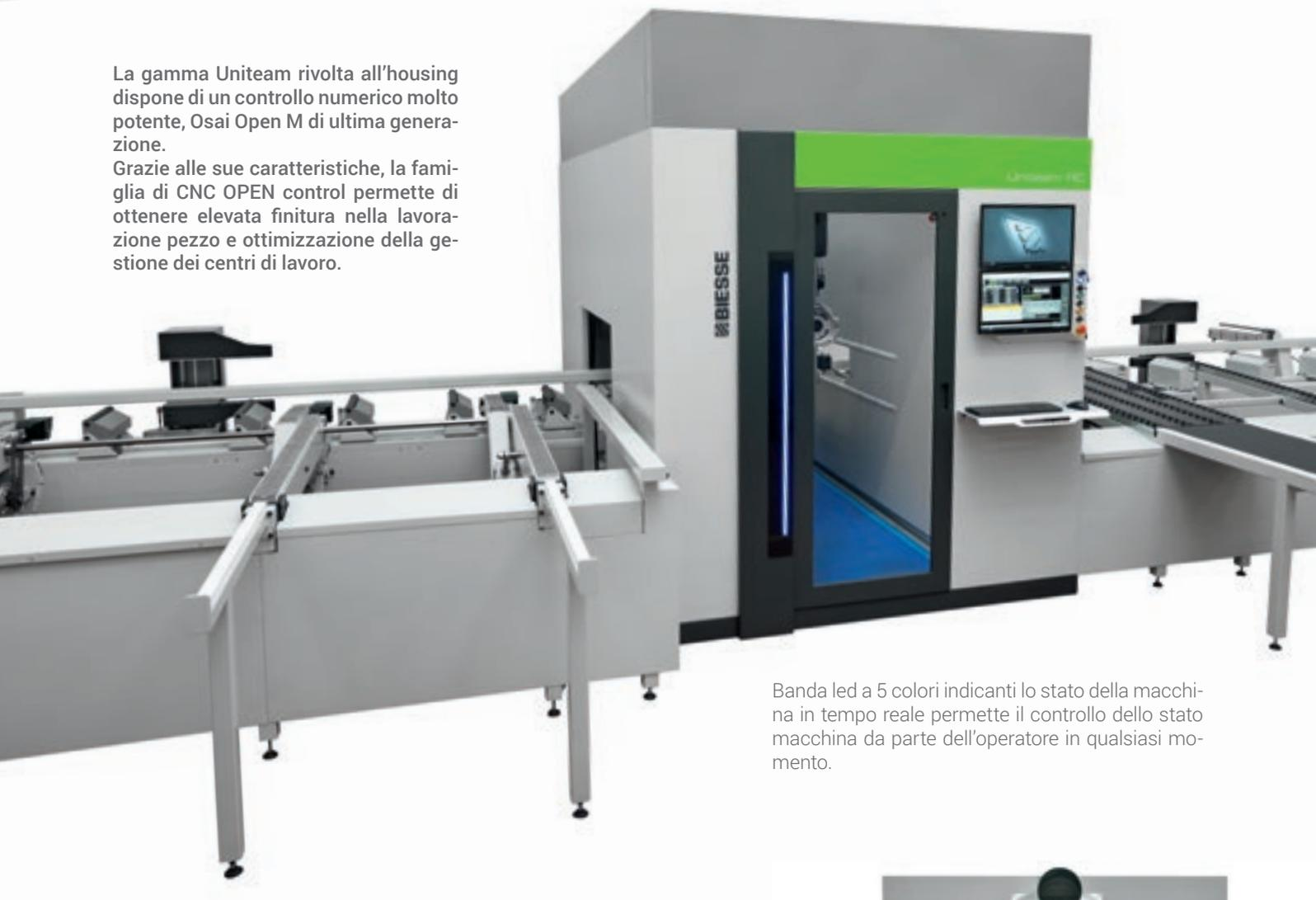
Banda led a 5 colori indicanti lo stato della macchina in tempo reale permette il controllo dello stato macchina da parte dell'operatore in qualsiasi momento.
