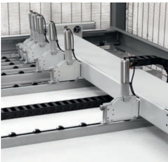
Accurato e rapido posizionamento dei pannelli per la massima precisione di taglio grazie al robusto carro spintore. Le pinze, indipendenti ed autolivellanti, garantiscono un tenace bloccaggio dei pannelli e consentono la completa espulsione dei pacchi sezionati fuori dalla linea di taglio.
