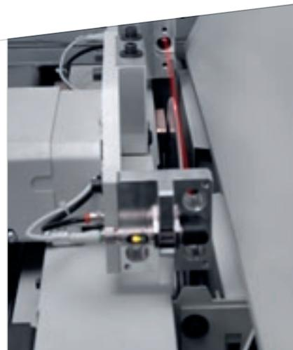
**Allineamento automatico dell'incisore.** Il sistema brevettato è in grado di allineare automaticamente l'incisore alla nuova lama, in pochi secondi. Consente di ridurre i tempi di attrezzaggio, i tagli di prova e la possibilità di errore con un incremento della produttività e una riduzione dei costi di gestione dell'affilatura.
