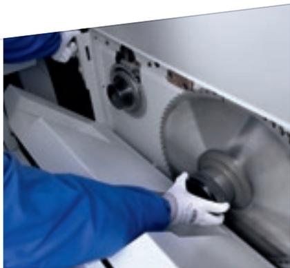
Il sistema "Quick change" è il dispositivo più **rapido, ergonomico e sicuro** per la sostituzione delle lame senza l'utilizzo di utensili.
