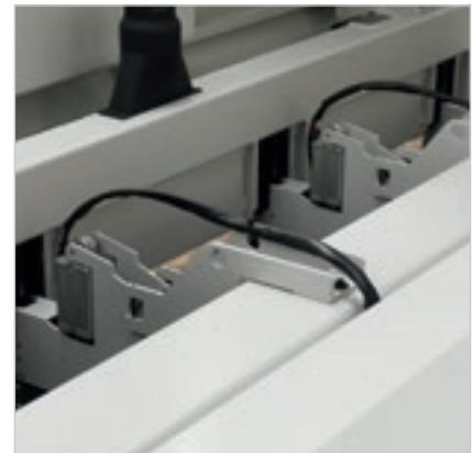
La pressione omogenea e controllata sul pacco di pannelli da tagliare è garantita dal **pressore** con struttura a singolo elemento.
