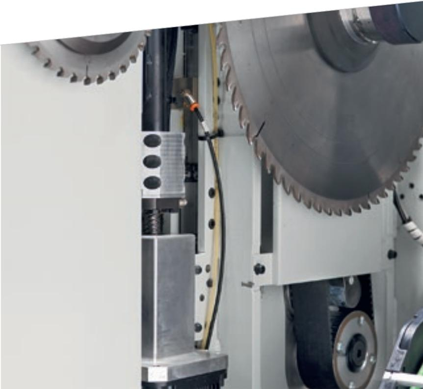
La **salita lame** è gestita tramite motore Brushless ed un sistema con vite a ricircolo di sfere. Tale sistema assicura una precisa e veloce regolazione della sporgenza della lama.
