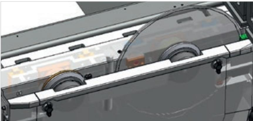
Il **dispositivo antisbandamento** controlla la posizione e il numero di giri della lama intervenendo sulla velocità di avanzamento. Massima qualità di taglio, maggiore vita della lama e riduzione dei costi di manutenzione.
