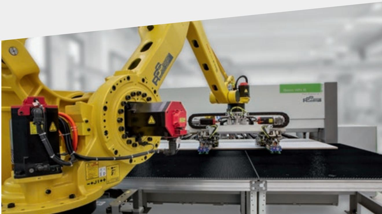
Il ciclo di lavoro viene eseguito in modalità automatica fino al completamento del lotto in lavorazione, in assenza dell'operatore. I tempi inattivi sono drasticamente ridotti e il rischio di danneggiamento del materiale derivante dalla manipolazione del pannello da parte dell'operatore è praticamente azzerato.
