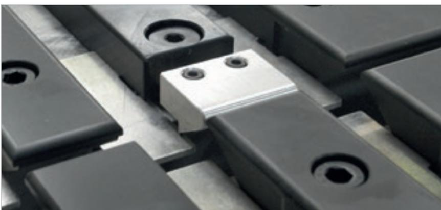
**Sistema di chiusura della linea di taglio** per evitare la caduta dei refili longitudinali.
