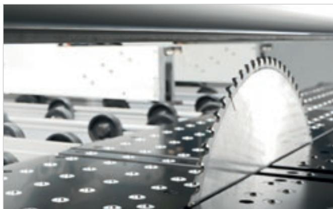
L'ottimale bilanciamento del carro porta utensile dovuto alla conformazione del basamento e al posizionamento delle guide e delle rotelle di scorrimento permette una totale assenza di vibrazioni della lama e un moto estremamente lineare del carro stesso.
