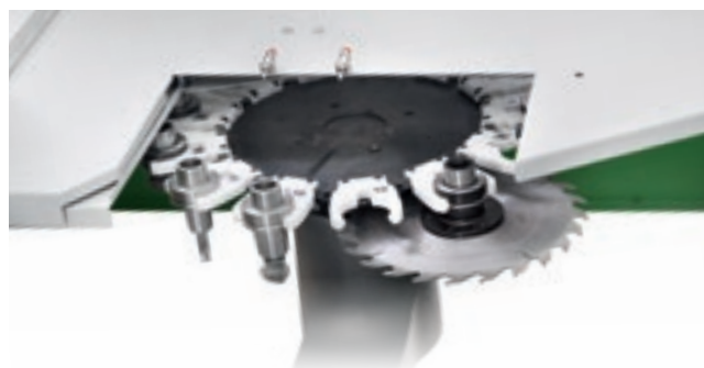
Magazzino utensili a revolver 13/16 posizioni.
