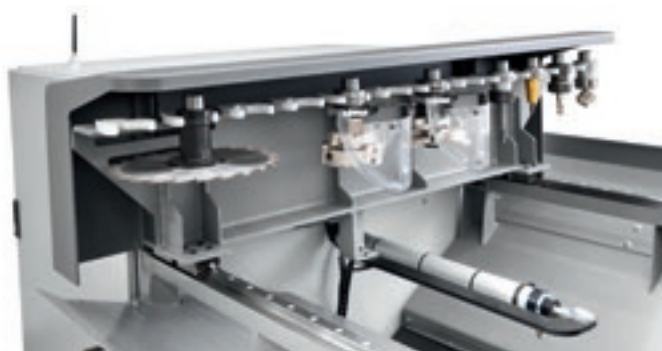
Magazzino utensili a rastrelliera 12 posizioni con pick up integrato.
