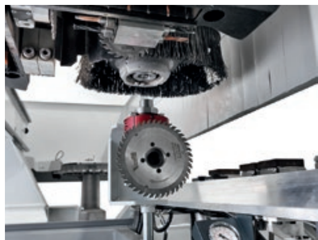
Il Pick Up permette di attrezzare i magazzini a bordo macchina.
