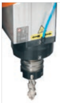
Motore verticale fisso dedicato a la- vorazioni accessorie di fresatura (slot, an- tischeggia, ...).
