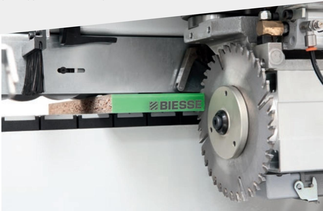
Affidabilità e precisione di taglio grazie al **Gruppo Intestatore** per eliminare l'eccedenza del bordo in testa e coda del pannello. Il Gruppo Intestatore prevede di serie il **Sistema Flex** che consente in automatico una regolazione dell'eccedenza del bordo.
