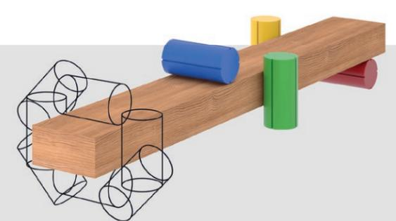
Il modello P.ONE 4+1 è corredato da un albero universale che, in quanto tale, permette la lavorazione del legno su uno dei 4 lati a seconda del prodotto finale che l'operatore vorrà ottenere, rendendo quindi la macchina estremamente versatile nel realizzare un'ampia gamma di lavorazioni.
