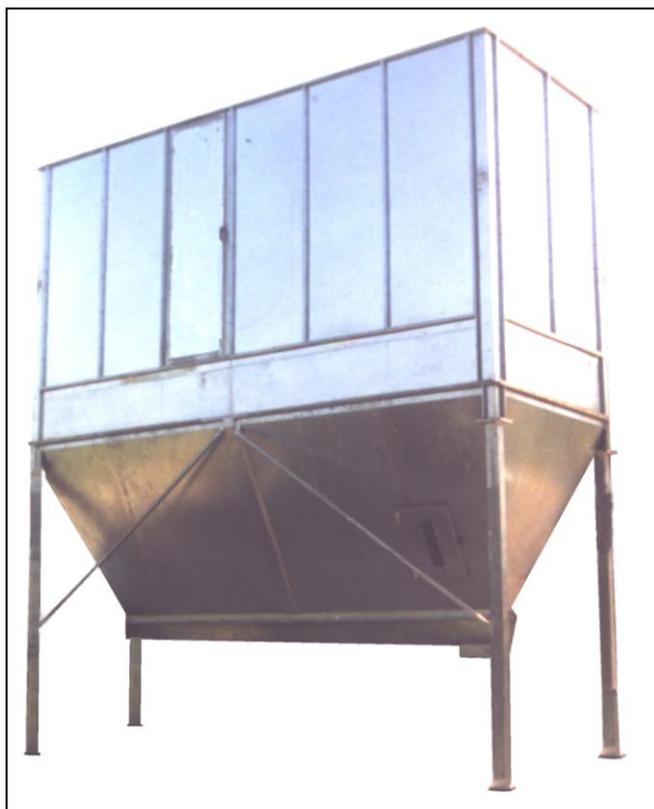
Sottostazione filtrante a maniche impiegata per l'aspirazione e la filtrazione di trucioli e polveri di legno.
